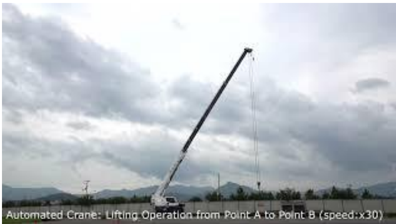
移動式クレーンによる、任意の地点間の荷の運搬作業 (平均荷揺れ精度10cm)
