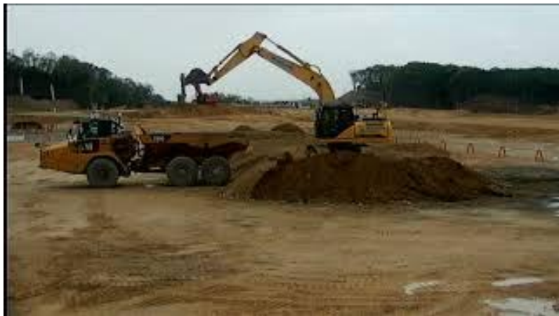
造成現場における、掘削後の土のダンプ積み込み作業の自動運転
